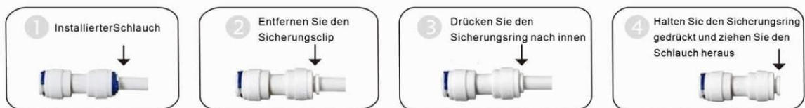
Entfernen von Schläuchen aus Schnellkupplung
