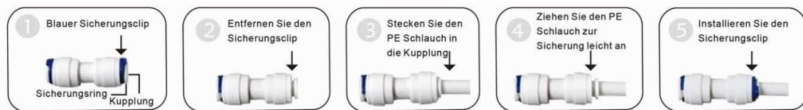
Verbindung von Schläuchen über Schnellkupplung (Schlauch hineinstecken)
