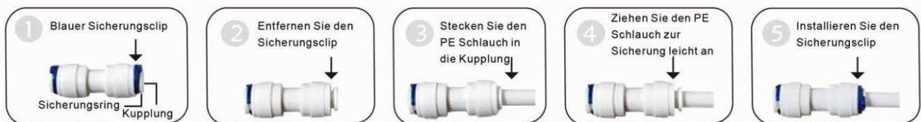
**Verbindung von Schläuchen über Schnellkupplung (Schlauch hineinstecken)**
