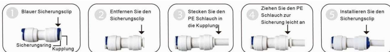
Verbindung von Schläuchen über Schnellkupplung (Schlauch hineinstecken)
