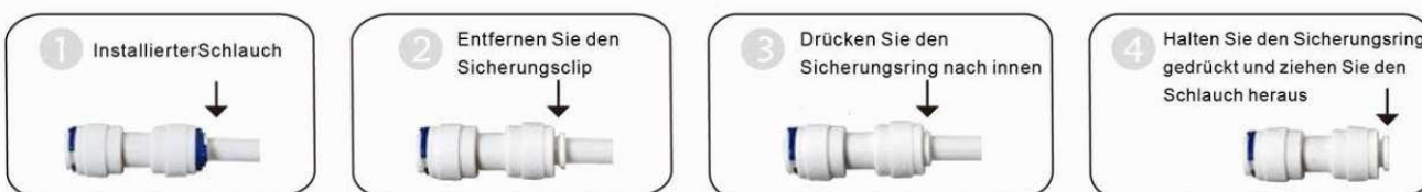
Entfernen von Schläuchen aus Schnellkupplung
