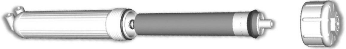
7. Stecken Sie die Membran wie abgebildet zentrisch in das Gehäuse.
