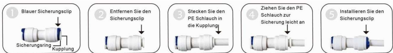
Verbindung von Schläuchen über Schnellkupplung (Schlauch hineinstecken)
