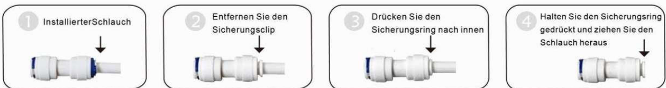
Entfernen von Schläuchen aus Schnellkupplung
