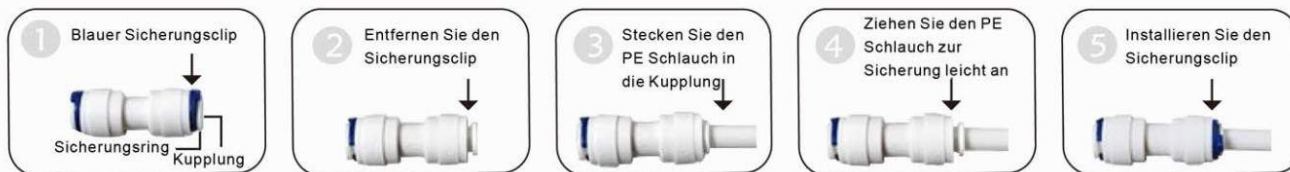
Verbindung von Schläuchen über Schnellkupplung (Schlauch hineinstecken)
