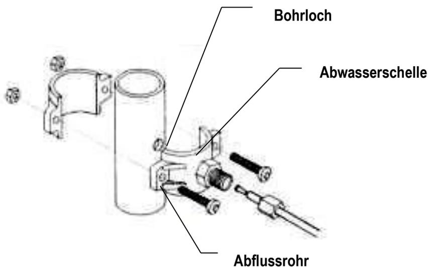
**Schließen Sie den schwarzen Schlauch jedoch noch nicht an die Abwasserschelle an**, da Sie während der Inbetriebnahme den Wasserfluss kontrollieren müssen. Stellen Sie sich dafür ein Gefäß bereit, in dem Sie das erste Wasser auffangen können.
