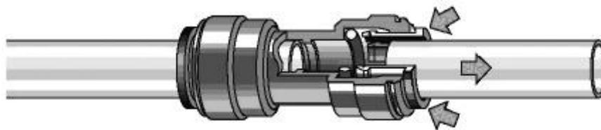
**Entfernen von Schläuchen aus Schnellkupplung nach JG-Prinzip**
