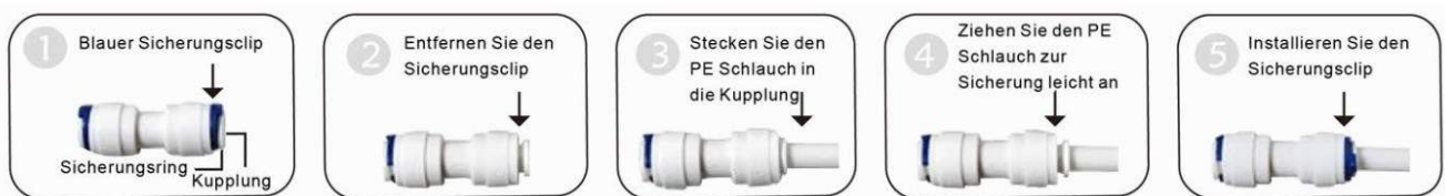
Verbindung von Schläuchen über Schnellkupplung (Schlauch hineinstecken)
