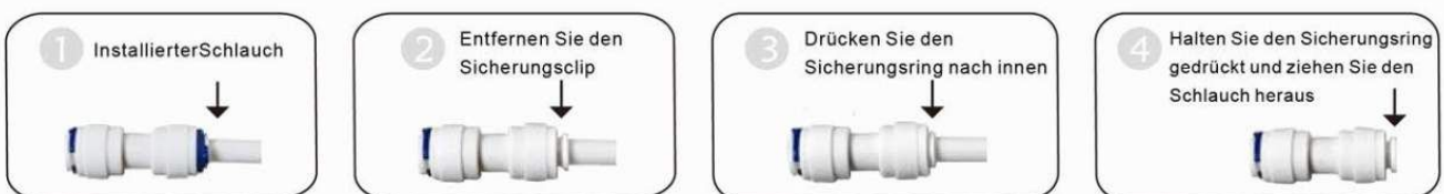
Entfernen von Schläuchen aus Schnellkupplung
