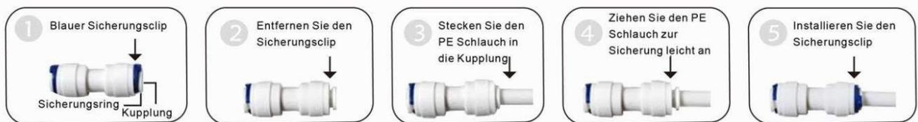
Verbindung von Schläuchen über Schnellkupplung (Schlauch hineinstecken)
