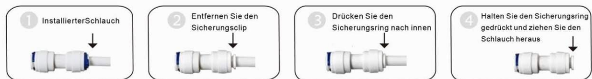
Entfernen von Schläuchen aus Schnellkupplung
