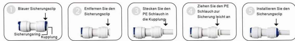
Verbindung von Schläuchen über Schnellkupplung (Schlauch hineinstecken)
