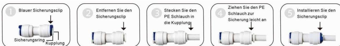
**Verbindung von Schläuchen über Schnellkupplung (Schlauch hineinstecken)**
