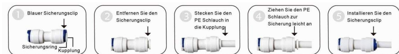
Verbindung von Schläuchen über Schnellkupplung (Schlauch hineinstecken)
