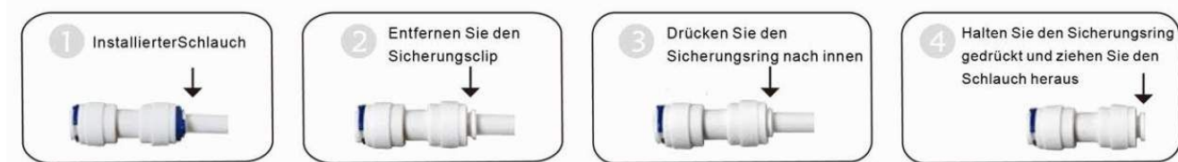
Entfernen von Schläuchen aus Schnellkupplung
